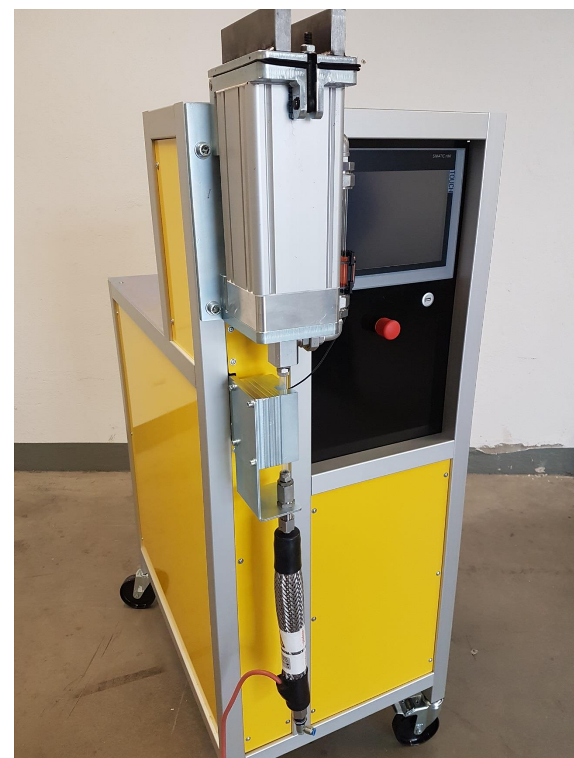
Pulsationseinrichtung zur Realisierung druckgepulster Harzinjektionen
