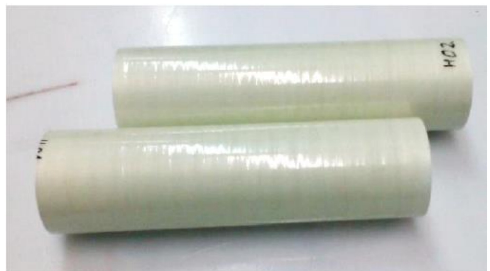
Halsrohre für ein Kryostaten-Mock-Up
