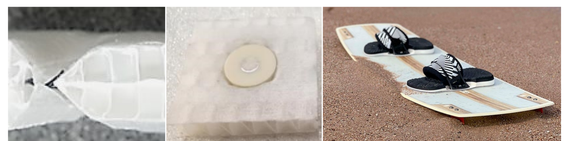
(li.) umgeformter Wabenkern, (mittig) integriertes Lasteinleitungselement, (re.) Demonstratorboard
