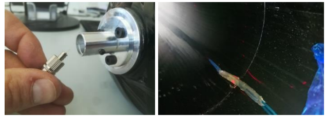
Bild 4: Sensorfaserbruch und -schädigung im Verarbeitungsprozess [4]
