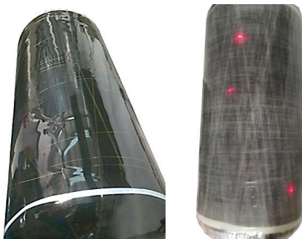
Bild 10: Applizierter Lichtwellenleiter auf einem Kunststoffliner (li.) und ausgehärteter Glasfaser-Druckbehälter mit eingestreutem Faserlicht (re.) [4]
