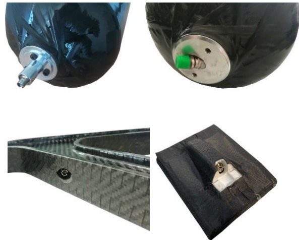
Bild 7: Beispielhafte Steckerintegration an rotations-symmetrischen (oben) und flächigen (unten) Strukturen [4]
