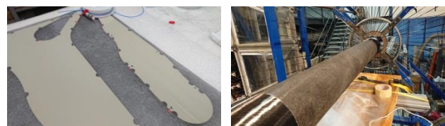
Bild 8: Sensorablage (li.) und Applikation der Trägerlage auf dem Bauteil (re.) [4]
