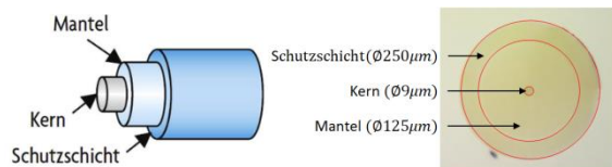
Bild 2: Aufbau optische Sensorfaser [3, 4]
