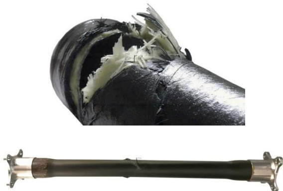
Bild 1: geborstener Druckbehälter (oben), versagte Antriebswelle (unten)
