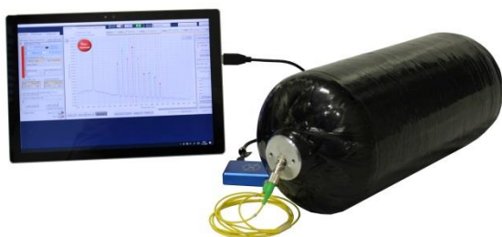
Bild 13: Druckbehälter mit 9 FBG-Sensoren [4]
