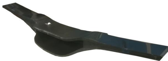
Bild 16: Längsträger eines Drehgestellrahmens mit integrierten FBG-Sensoren in Prepreg-Autoklav Bauweise [4]
