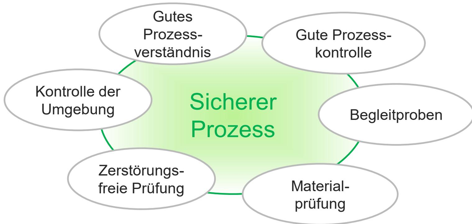
Faserverbundherstellung ist ein „Spezialprozess“ bei dem die Materialeigenschaften erst im Prozess der Bauteilherstellung entstehen.
